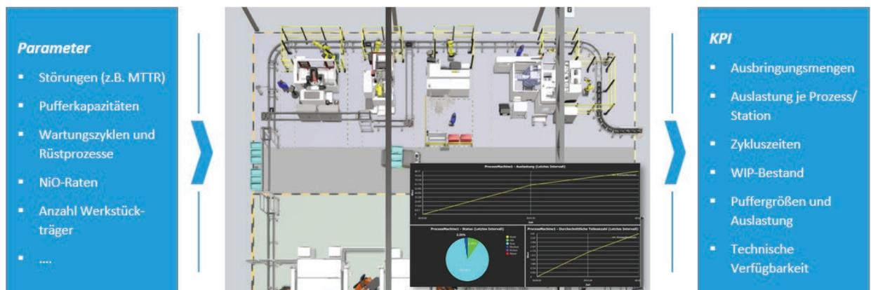
Abbildung 2: Parameter und KPI für die Materialflusssimulation
